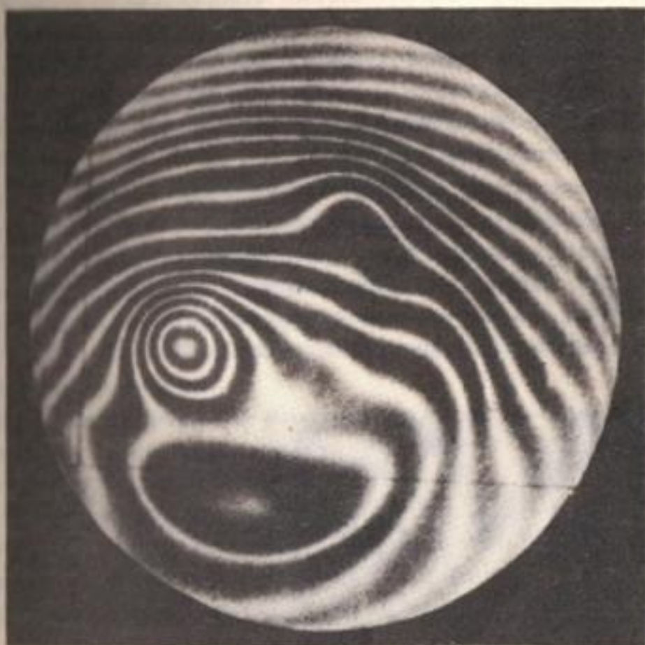
Рис. 14. Интерферограмма сферической оболочки
