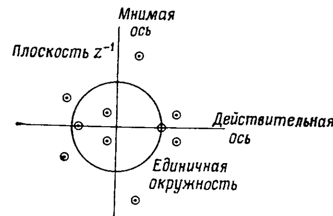
Фиг. 6.7. Конфигурация нулей, определяющая нерекурсивный фильтр.
