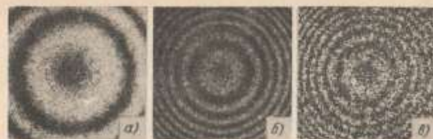
Рис. 46. Влияние шага топографических сечений на контраст интерференционных полос: а - \Delta h = 470 мкм; б - \Delta h = 64 мкм; в - \Delta h = 30 мкм
