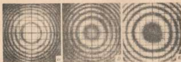
Рис. 39. Топограммы эталонной плоскости, полученные при различных параметрах схемы записи
