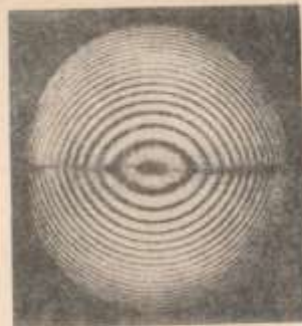
Рис. 25. Топограмма образца минерала при наклонном освещении
