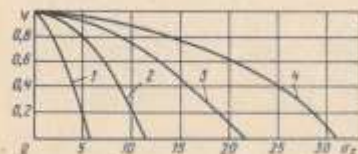
Рис. 125. Зависимость среднего квадратического отклонения яркости изображения от разрешающей способности оптической системы и связанный с ней зависимость максимального среднего квадратического отклонения яркости изображения от дисперсии шероховатости
