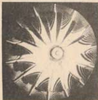
Рис. 129. Интерферограмма вибрирующего латунного диска с лопатками
