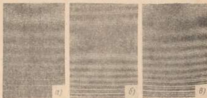
Рис. 91. Муар механического дифференцирования интерференционных сплошных консольных пластин. Верхний ряд получены при сдвиге вдоль оси Oy на 10 мкм; а, б — для стального образца без подкрепления и с подкреплением соответственно; в — для образца из органического стекла. Нижний ряд получен при сдвиге вдоль оси Ox на 10 мкм; г — для стального образца без подкрепления; д — для образца из органического стекла
