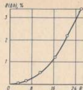
Рис. 44. Зависимость погрешности шага сечений от углового размера объекта в иммерсионном методе
