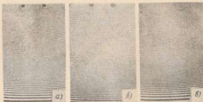
Рис. 88. Картины интерференционных полос при изгибе гладких консольных пластин: a — стальной образец без подкрепления; b — стальной образец с ребром жесткости; c — образец из органического стекла без подкрепления
