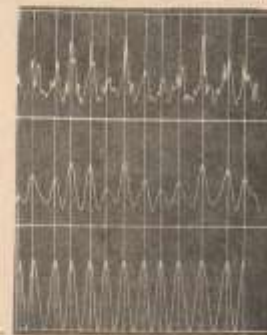
Рис. 115. Частотная фильтрация при практически перекрывающихся спектрах сигнала и помехи
