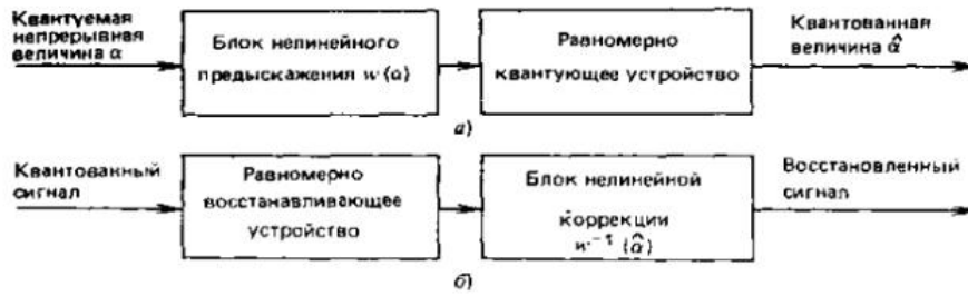
Рис. 2.10: Схемы оптимального квантования (а) и восстановления (б) с нелинейным предискажением и коррекцией
