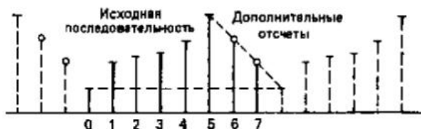
Рис. 4.7. Доопределение последовательности при вычислении свертки с помощью ДПФ
