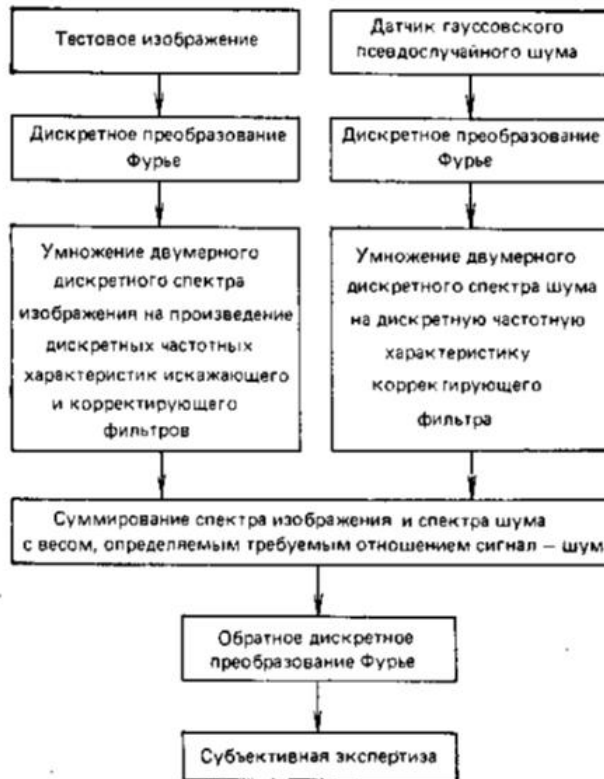
Рис. 6.11. Схема цифровой модели оптической системы коррекции дефокусированных изображений
