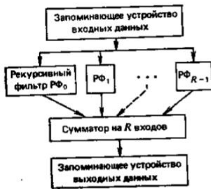
Рис. 4.10. Схема параллельной рекурсивной организации цифровых фильтров
