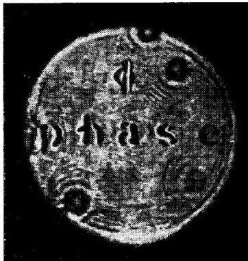
Рис. 6.35. Изображение фазового предмета, полученное путем визуализации восстановленного фазового изображения с помощью ножа Фуко. Отчетливо виден перекося изображения, характерный для этого метода.
