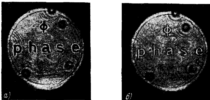
Рис. 6.33. Изображение фазового предмета, полученное путем визуализации восстановленного фазового изображения методом небольшой дефокусировки. а) Плоскость наблюдения \xi выбрана на расстоянии \frac{3}{4} f_2 от линзы L_2 ; б) плоскость наблюдения \xi выбрана на расстоянии \frac{5}{4} f_2 от линзы L_2 . Видно, что при приближении плоскости \xi к линзе L_2 наблюдается «темный» контраст, а при удалении плоскости \xi от линзы L_2 наблюдается «светлый» контраст.
