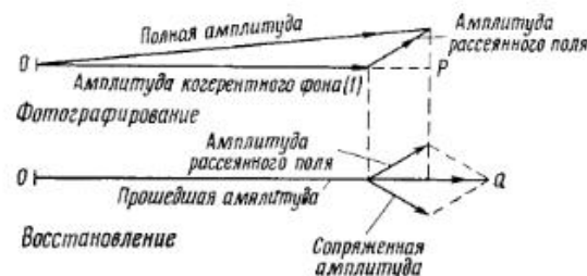
Рис. 1. Векторная диаграмма, объясняющая принцип восстановления для коэффициента контрастности \Gamma = 2 .
