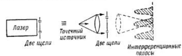
Рис. 3. Эквивалентность пространственно-когерентного лазерного освещения и когерентного освещения по схеме рис. 1 с некогерентным или когерентным источником.
