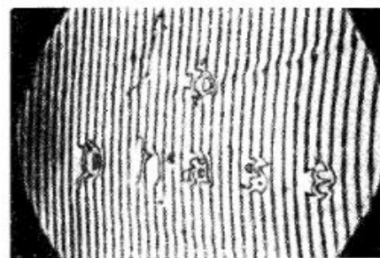
Рис. 24. Интерферограмма, полученная методом последовательного сложения голографических интенсивностей на одной голограмме [15].
