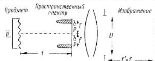
Рис. 7. Критерий разрешения Аббе при когерентном освещении. (Эквивалентный критерий Релея рассматривается на рис. 8.)
