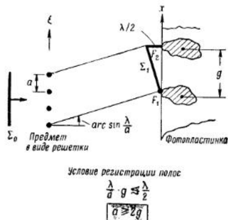
Рис. 17. Ограниченная разрешающая способность обычной голографии Френеля, обусловленная зернистостью фотоэмульсии.
