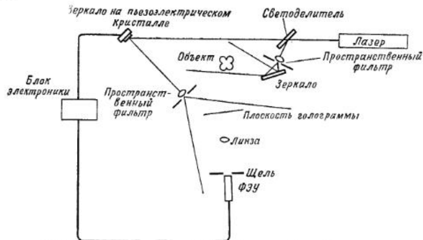
Рис. 26. Схема голографической установки с обратной связью.
