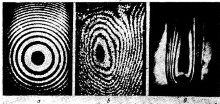
Рис. 8.14. Фотографии интерферограмм, полученных методом двойной экспозиции: а — плоскопараллельной стеклянной пластинки; б — плоской стеклянной пластинки; в — пламени.
