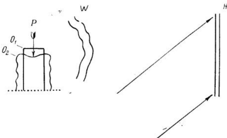
Рис. 39. Общая схема метода голографической интерферометрии. На одной и той же фотопластинке  $H$  записываются голограмма предмета, находящегося в исходном состоянии  $O_1$ , и голограмма этого же предмета, деформированного под действием нагрузки  $P$ . При реконструкции оба изображения восстанавливаются одновременно, соответствующее им излучение интерферирует, и деформации выявляются в виде интерференционных полос на восстановленном изображении
