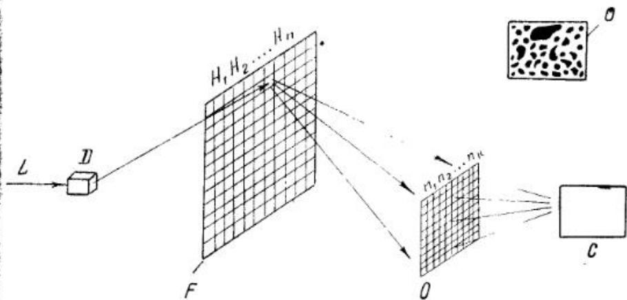
Рис. 44. Принципиальная схема устройства памяти электронно-вычислительной машины. По команде счетного устройства луч когерентного излучения  $L$  направляется на голограмму  $H_n$ , на которой записана искомая страница информации. Изображение этой страницы восстанавливается в плоскости  $O$ , считывается матрицей фотоприемников и подается на вход счетного устройства  $C$ .
