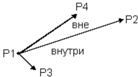
Векторным произведением двух векторов  $V=(V_x, V_y)$  и  $W=(W_x, W_y)$  принадлежащим плоскости  $(x, y)$  является вектор, значение  $Z$ -компоненты которого есть  $V_x W_y - V_y W_x$ . Если эта величина отрицательна, проверяемая точка лежит внутри. Если положительна, то вне.
