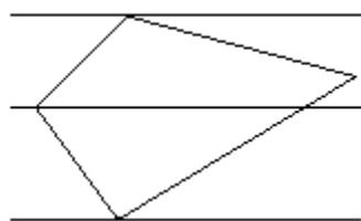
Дополнительная трудность возникает при пересечении сканирующей строки и многоугольника точно по вершине. Правильный результат можно получить, учитывая точку пересечения в вершине два раза, если она является точкой локального минимума или максимума, или учитывая ее один раз в противном случае.
