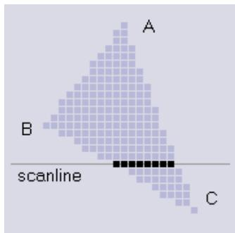
Рассмотрим какую-то линию  $sy$ ,  $A.y \leq sy \leq C.y$ . Если  $sy < B.y$ , то она пересекает стороны  $AB$  и  $AC$ ; если  $sy \geq B.y$  - то стороны  $BC$  и  $AC$ . Мы знаем координаты всех вершин, поэтому мы можем написать уравнения сторон и найти пересечение нужной стороны с прямой  $y = sy$ . Получим два конца отрезка. Так как мы не знаем, какой из них левый, а какой правый, сравним их координаты по  $x$  и обменяем значения, если надо.
