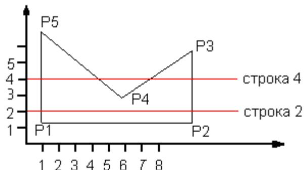
Строка 2 пересекает многоугольник в точках  $X=1$  и  $X=8$ . Получаем три области: две вне, одна внутри. Строка 4 делится на пять областей. Точки пересечения необходимо отсортировать в возрастающей последовательности.
