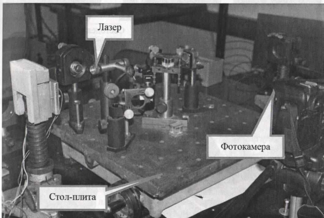
Рис. 1. Интерференционная система (общий вид)
