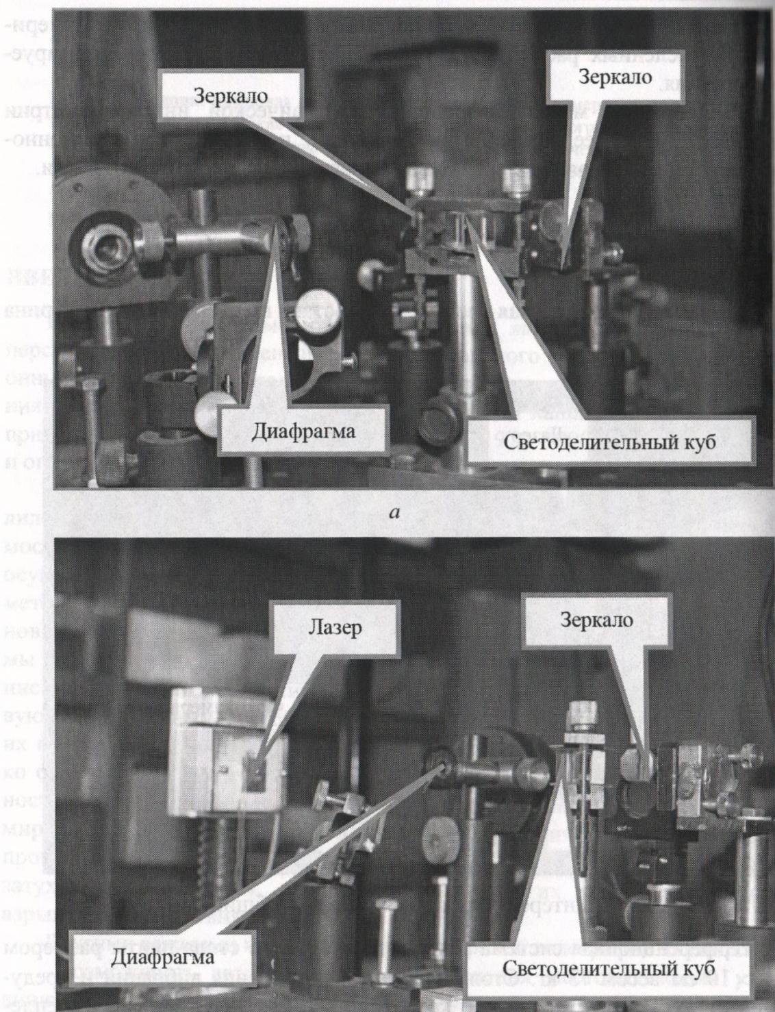
Рис. 2. Цифровая голограммическая система:
