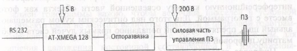
Рис. 3. Схема управления пьезокерамическим актиоатором
