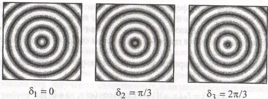
Рис. 2. Интерференционные картины с разными фазовыми сдвигами
