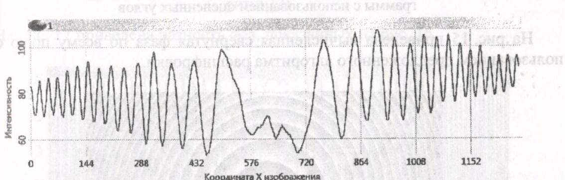
Рис. 13. Профиль поля интенсивности в среднем сечении экспериментальной интерференционной картины со сдвигом  $\delta_1$
