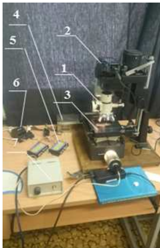
Рис. 5 Модифицированный оптический микроскоп: 1 – микроскоп; 2 – фотоаппарат; 3 – автоматизированный предметный столик; 4 – БП на 12 В; 5 – контроллер шагового двигателя; 6 – преобразователь интерфейса RS-485\RS-232; 7 – осветитель
