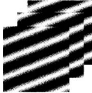
Рис. 1. Интерферограммы, образованные при интерференции двух плоских пучков с фазовыми сдвигами
