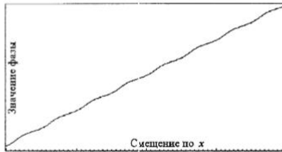
Рис. 2. Фазовые значения, полученные с помощью четырехточечного алгоритма, при 20 %-ной линейной ошибке. Действительная фаза — идеальная линейная функция
