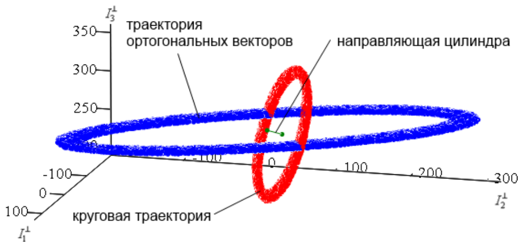
Рисунок 6 — Преобразование к круговой траектории (проецирование по направляющей цилиндра)
