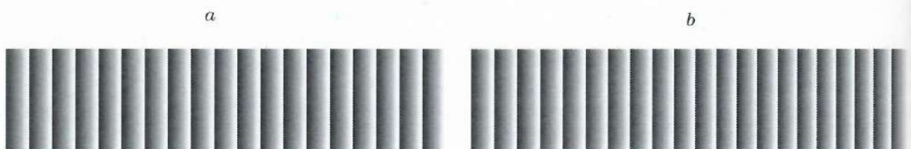
Рис. 3. Фазовые распределения изображений объекта при проекции на него 20 полос: до нагрузки (а) и после нагрузки (б)
