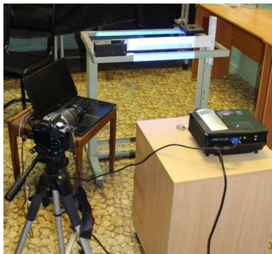
Рис. 1. Фотография установки для регистрации профиля объектов
